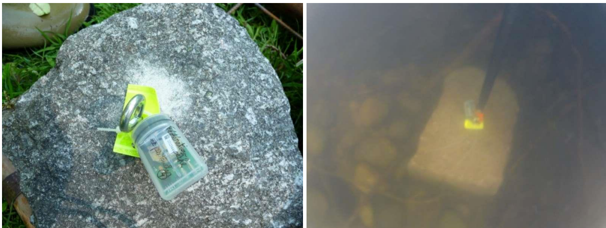
Figure 34 : photo du dispositif bloc-sonde thermique
