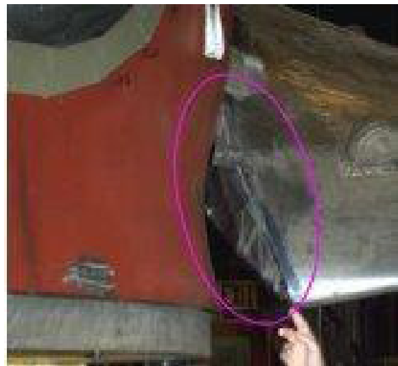
Abbildung 24: Kaplan-turbine, Laufradspalte nabenseitig (Foto: Voith Hydro).
