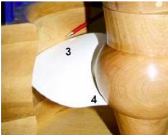
Abbildung 22: « minimum gap »-Turbine, Kugelform am Übergang zu Nabe (4) und aussenliegendem Laufradmantel (3) garantiert bei Laufradverstellung (Drehung) die Einhaltung minimaler Spalte (Modell: Voith Hydro).
