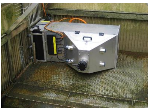
In Fischpass installierter Riverwatcher sowie Beispiele Erfolgskontrolle (Quelle: Homepage I am Hydro)
