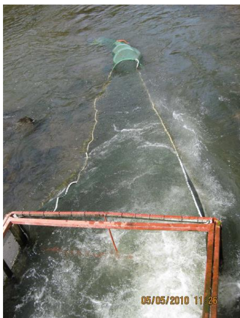
Lochblechkasten mit Hamen und anschließender Fangreuse (links; Schmalz, 2010 7 ); Konstruktions- skizze Hamennetz (rechts; Pulg & Schnell, 2015 8 )
