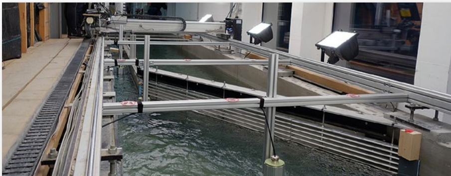
Les grilles de guidage, ici en tant qu'installation de test de l'EPF de Zürich, pourraient réduire la mortalité piscicole lors du passage vers l'aval des centrales hydroélectriques.
